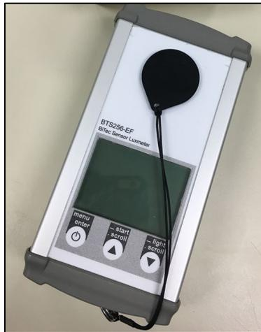
Figure 12. Gigahertz-Optik BTS256-EF handheld flicker meter.
